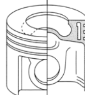
Поршень (типа FCD) для ускорения топлива
